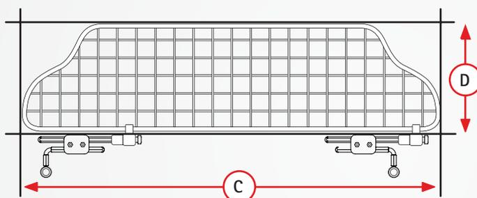
Das Besondere an diesem Trenngitter sind Einbuchtungen im oberen Rahmenbereich, dadurch passt das Gitter auch in Fahrzeuge, die oben schmaler verlaufen als im Bereich der Kopfstützen. Inklusive aller Montageteile sowie Werkzeug.
